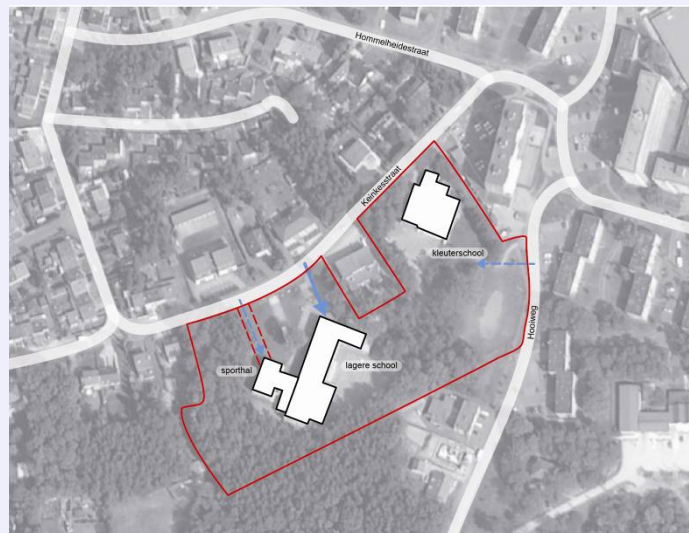
Site van Europaschool in Genk. Aparte ontsluiting voor de sportzaal onafhankelijk van de school. AGION.
