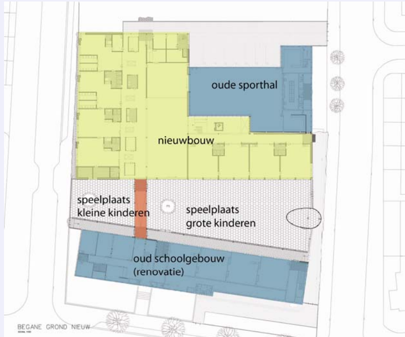
Grondplan 0 met aanduiding van delen nieuwbouw, renovatie en verbinding tussen beide. Bron: KdV Architectuur, bewerking: AGION.
